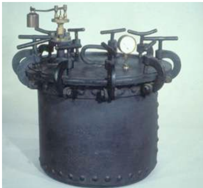
世界初の高圧蒸気滅菌器（1880）
